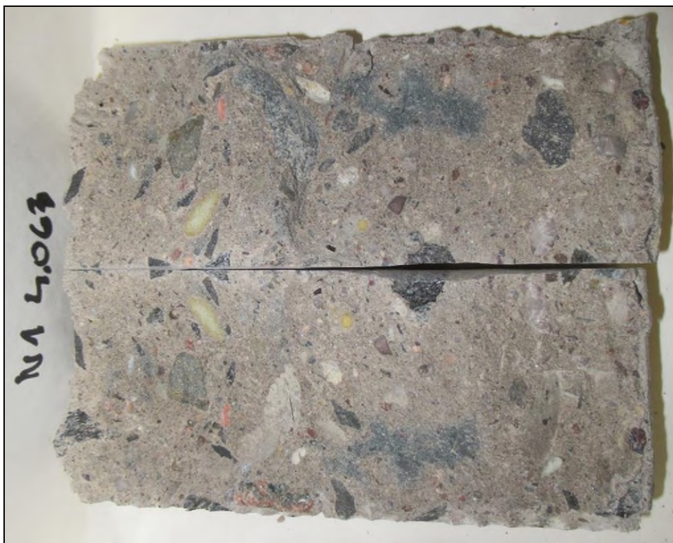
Foto 2: Části vzorku N1 před zkouškou na přítomnost ASR
