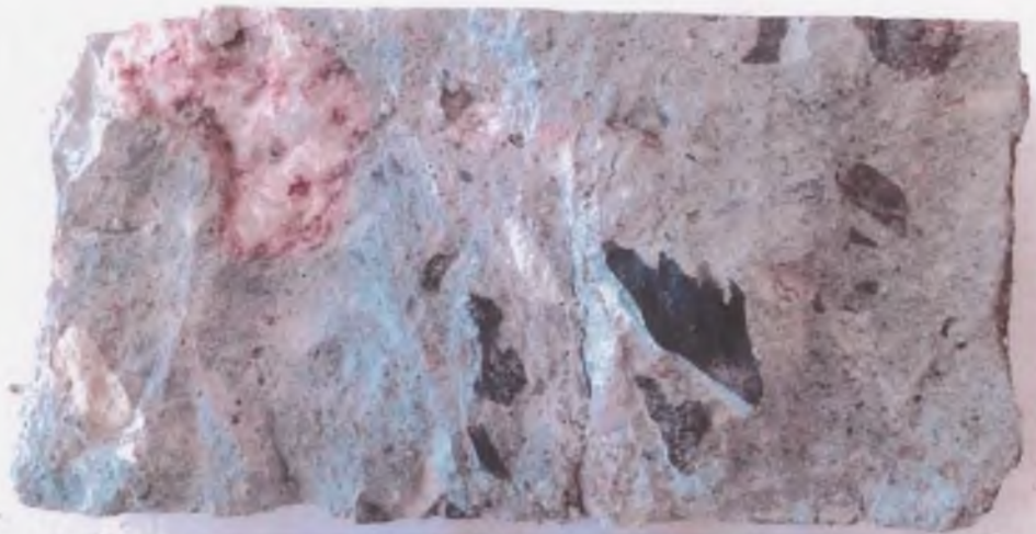
Obrázek č. 3: Fotodokumentace vývrtu 11/1-M1 – 2. polovina délky, pohled na zkoušenou lomovou plochu
