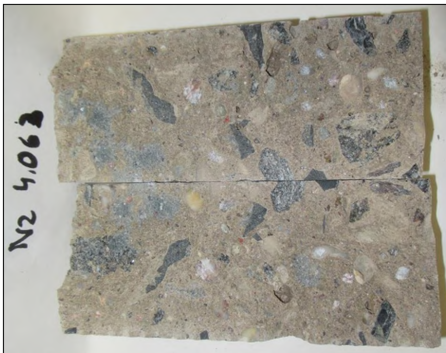
Foto 4: Části vzorku N2 před zkouškou na přítomnost ASR
